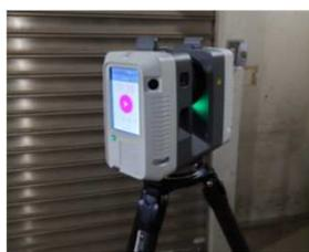
3Dスキャンは、3Dレーザーキャナーという機器を使用して行います。空間、設備のあらゆる形状を取得したデータは、**点群**と呼びます。1回のデータ取得で何万点もの点を取得します。（設定によりスキャン時間は異なります）※点群については、次ページをご覧ください。
